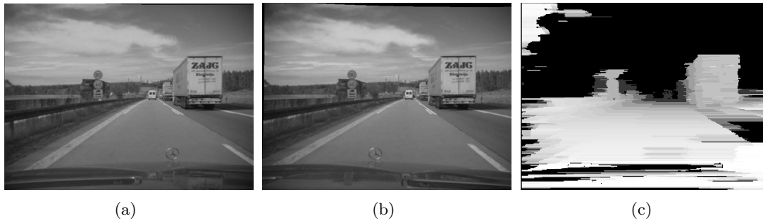
Abbildung 3.2.: (a) und (b) Linkes und rechtes Kamerabild, rektifiziert. (c) Disparitätsbild erzeugt mit dynamischer Programmierung, siehe Abschnitt 3.3.
