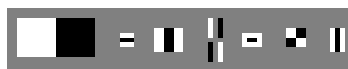
Abbildung 11.2.: Optimierte Merkmale für Fußgängererkennung. Die Merkmale sind 16 \times 8 , 3 \times 3 , 6 \times 5 , 3 \times 9 , 4 \times 3 , 4 \times 4 und 3 \times 5 Pixel groß.
